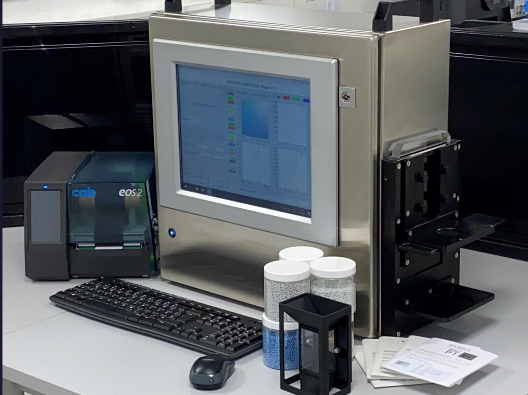
Laborfarbmessgerät SPECTRO-3-0°/45°-MSM-LAB-ANA-P mit eos2 Etikettendrucker und RAL - Kunststoffkarten, sowie Rezyklatproben
